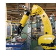
ロボット溶接加工
